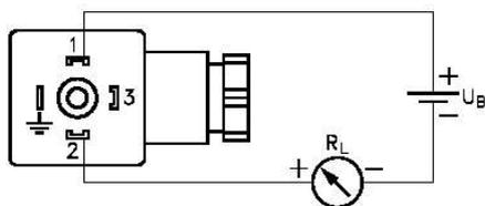
Электрическое подключение преобразователя с выходным сигналом 4 – 20 мА
